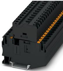
Bloc de jonction-fusibles, type de fusible: Verre / Céramique / ..., type de fusible: G / 6,3 x 32, tension nominale: 60 V, intensité nominale: 10 A, type de raccordement: Raccordement Push-in, Section de référence: 6 mm<sup>2</sup>, section : 0,5 mm<sup>2</sup>- 10 mm<sup>2</sup>, type de montage: NS 35/7,5, NS 35/15, coloris: noir
