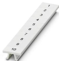
Ruban de repérage ZB, Rubans, blanc, repéré, repérable avec : CMS-P1-PLOTTER, impression transversale: numérotation continue 1 ... 10, 11 ... 20, etc. jusqu'à 491 ... 500, type de montage: encliquetage, pour bloc de jonction au pas de : 6,2 mm, surface utile: 6,15 x 10,5 mm, Nombre d'étiquettes: 10
