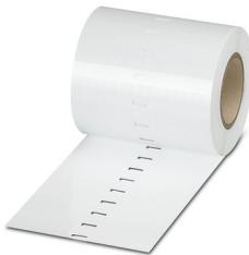
Repères pour blocs de jonction, Rouleau, blanc, vierge, repérable avec : THERMOMARK ROLL 2.0, THERMOMARK ROLL, THERMOMARK ROLL X1, THERMOMARK ROLLMASTER 300/600, THERMOMARK X1.2, THERMOMARK S1.1, perforé, type de montage: encliquetage, encliquetage dans la rainure de repérage plate, pour bloc de jonction au pas de : 6,2 mm, surface utile: 6,35 x 6,15 mm, Nombre d'étiquettes: 16000
