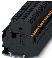
Bloc de jonction-fusibles, type de fusible: Verre / Céramique / ..., type de fusible: G / 6,3 x 32, tension nominale: 630 V, intensité nominale: 10 A, type de raccordement: Raccordement Push-in, Section de référence: 6 mm<sup>2</sup>, section : 0,5 mm<sup>2</sup>- 10 mm<sup>2</sup>, type de montage: NS 35/7,5, NS 35/15, coloris: noir
