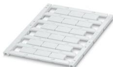
Repères pour blocs de jonction, à commander : sous forme de planche, blanc, impression selon les indications du client, type de montage: encliquetage dans la rainure de repérage élevée, pour bloc de jonction au pas de : 16 mm, surface utile: 14,8 x 9,6 mm, Nombre d'étiquettes: 18
