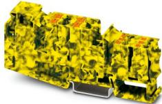
Borne collectrices de potentiel, tension nominale: 1000 V, intensité nominale: 105 A, nombre de connexions: 11, type de raccordement: Raccordement vissé, 1er étage connexion à gauche, section : 1,5 mm<sup>2</sup> - 50 mm<sup>2</sup>, Raccordement Push-in, 1er étage raccordement intérieur, Section de référence: 6 mm<sup>2</sup>, section : 0,5 mm<sup>2</sup> - 10 mm<sup>2</sup>, type de montage: NS 35/7,5, NS 35/15, coloris: noir/jaune
