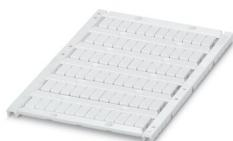
Repères pour blocs de jonction, à commander : sous forme de planche, blanc, impression selon les indications du client, type de montage: encliquetage dans la rainure de repérage élevée, pour bloc de jonction au pas de : 5,2 mm, surface utile: 4,6 x 10,5 mm, Nombre d'étiquettes: 72
