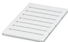
Repères pour blocs de jonction, à commander : sous forme de planche, blanc, impression selon les indications du client, type de montage: encliquetage dans la rainure de repérage élevée, pour bloc de jonction au pas de : 12 mm, surface utile: 11,45 x 10,5 mm, Nombre d'étiquettes: 40
