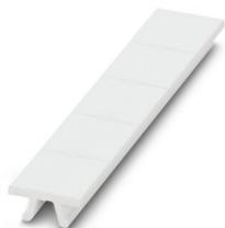
Ruban de repérage ZB, à commander : par bandes, blanc, impression selon les indications du client, type de montage: encliquetage dans la rainure de repérage élevée, pour bloc de jonction au pas de : 12,2 mm, surface utile: 10,5 x 12,15 mm, Nombre d'étiquettes: 5
