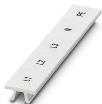
Ruban de repérage ZB, Rubans, blanc, repéré, impression longitudinale: L1, L2, L3, N, PE, type de montage: encliquetage, pour bloc de jonction au pas de : 12,2 mm, surface utile: 10,5 x 12,15 mm, Nombre d'étiquettes: 5
