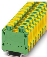
Bloc de jonction pour conducteur de protection, avec base fileté, nombre de connexions: 2, type de raccordement: Raccordement vissé, Section de référence: 16 mm<sup>2</sup>, section : 1,5 mm<sup>2</sup> - 25 mm<sup>2</sup>, type de fixation: Pied PE avec vis de fixation, M4, type de montage: NS 35/7,5, NS 35/15, coloris: vert/jaune
