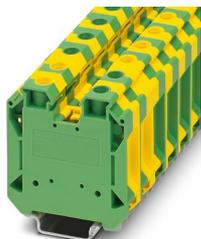
Bloc de jonction pour conducteur de protection, avec base fileté, nombre de connexions: 2, type de raccordement: Raccordement vissé, Section de référence: 35 mm<sup>2</sup>, section : 1,5 mm<sup>2</sup> - 35 mm<sup>2</sup>, type de fixation: Pied PE avec vis de fixation, M5, type de montage: NS 35/7,5, NS 35/15, coloris: vert/jaune
