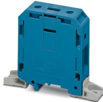
Bloc de jonction de puissance, tension nominale: 1000 V, intensité nominale: 192 A, nombre de connexions: 2, nombre de pôles: 1, type de raccordement: Raccordement vissé, Section de référence: 70 mm<sup>2</sup>, section : 16 mm<sup>2</sup> - 70 mm<sup>2</sup>, type de montage: vissage direct, coloris: bleu
