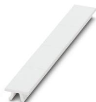
Ruban de repérage ZB, à commander : par bandes, blanc, impression selon les indications du client, type de montage: encliquetage dans la rainure de repérage élevée, pour bloc de jonction au pas de : 22 mm, surface utile: 10,5 x 21,8 mm, Nombre d'étiquettes: 4
