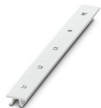
Ruban de repérage ZB, Rubans, blanc, repéré, impression longitudinale: L1, L2, L3, N, PE, type de montage: encliquetage, pour bloc de jonction au pas de : 22 mm, surface utile: 10,5 x 21,8 mm, Nombre d'étiquettes: 50
