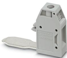
Bloc de jonction de dérivation, tension nominale: 1000 V, intensité nominale: 57 A, nombre de connexions: 1, type de raccordement: Raccordement vissé, Section de référence: 10 mm<sup>2</sup>, section : 0,5 mm<sup>2</sup> - 10 mm<sup>2</sup>, type de montage: sur embase, coloris: gris
