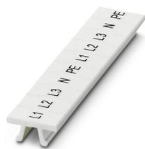
Ruban de repérage ZB, Rubans, blanc, repéré, longitudinal: L1, L2, L3, N, PE, L1, L2, L3, N, PE, type de montage: encliquetage, pour bloc de jonction au pas de : 5,2 mm, surface utile: 5,15 x 10,5 mm, Nombre d'étiquettes: 10
