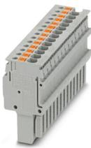
Connecteurs, tension nominale: 500 V, intensité nominale: 17,5 A, nombre de connexions: 14, nombre de pôles: 14, type de raccordement: Raccordement Push-in, 1er étage, Section de référence: 1,5 mm<sup>2</sup>, section : 0,14 mm<sup>2</sup> - 1,5 mm<sup>2</sup>, coloris: gris
