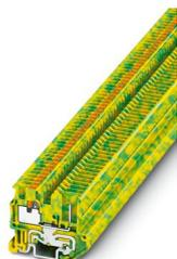
Bloc de jonction pour conducteur protection miniature, nombre de connexions: 2, type de raccordement: Raccordement Push-in, 1er étage, section : 0,14 mm<sup>2</sup> - 1,5 mm<sup>2</sup>, type de montage: NS 15, coloris: vert/jaune
