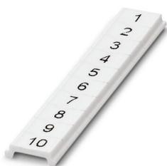
Ruban de repérage ZB, plat, Rubans, blanc, repéré, impression transversale: numérotation continue 1 ... 10, 11 ... 20, etc. jusqu'à 91 ... 100, type de montage: encliquetage, pour bloc de jonction au pas de : 3,5 mm, surface utile: 5,15 x 3,5 mm, Nombre d'étiquettes: 10
