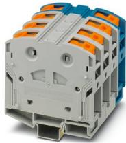
Bloc de jonction de puissance, bloqué, tension nominale: 1000 V, intensité nominale: 232 A, nombre de connexions: 8, nombre de pôles: 4, type de raccordement: Raccordement PowerTurn, 1er étage, section : 25 mm<sup>2</sup> - 95 mm<sup>2</sup>, type de montage: NS 35/15, coloris: gris/bleu
