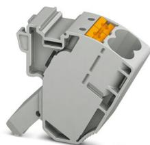
Bloc de jonction de dérivation, tension nominale: 1500 V, intensité nominale: 57 A, nombre de connexions: 2, type de raccordement: Raccordement Push-in, 1er étage, Section de référence: 10 mm<sup>2</sup>, section : 0,5 mm<sup>2</sup> - 16 mm<sup>2</sup>, type de montage: sur embase, coloris: gris
