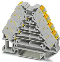
Connecteurs sous-répartiteurs, tension nominale: 250 V, intensité nominale: 10 A, type de raccordement: Raccordement Push-in, 1., 2., 3. und 4. Etage, Section de référence: 1,5 mm<sup>2</sup>, section : 0,14 mm<sup>2</sup> - 2,5 mm<sup>2</sup>, montage: NS 35/7,5, NS 35/15, coloris: gris, couleur des éléments de raccordement: jaune
