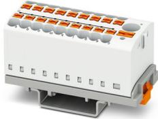
Bloc distributeur, Bloc avec orientation verticale et alimentation intégrée, tension nominale: 690 V, intensité nominale: 24 A, nombre de connexions: 19, type de raccordement: Raccordement Push-in, Dérivation, section : 0,14 mm<sup>2</sup> - 4 mm<sup>2</sup>, Raccordement Push-in, Raccordement collectif, Section de référence: 6 mm<sup>2</sup>, section : 0,5 mm<sup>2</sup> - 10 mm<sup>2</sup>, type de montage: NS 35/7,5, NS 35/15, coloris: blanc
