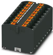
Bloc distributeur, Module de base, tension nominale: 450 V, intensité nominale: 24 A, nombre de connexions: 18, type de raccordement: Raccordement Push-in, section : 0,14 mm<sup>2</sup> - 4 mm<sup>2</sup>, type de montage: encliquetage sur l'adaptateur de profilé, Montage direct avec bride, Volant, coloris: noir
