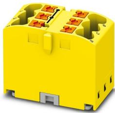
Bloc distributeur, Module de base, tension nominale: 450 V, intensité nominale: 24 A, nombre de connexions: 6, type de raccordement: Raccordement Push-in, section : 0,14 mm<sup>2</sup> - 4 mm<sup>2</sup>, type de montage: collage, coloris: jaune
