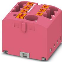
Bloc distributeur, Module de base avec alimentation, tension nominale: 450 V, intensité nominale: 41 A, nombre de connexions: 7, type de raccordement: Raccordement Push-in, Raccordement collectif, Section de référence: 6 mm<sup>2</sup>, section : 0,5 mm<sup>2</sup> - 10 mm<sup>2</sup>, Raccordement Push-in, Dérivation, section : 0,14 mm<sup>2</sup> - 4 mm<sup>2</sup>, type de montage: collage, coloris: rose
