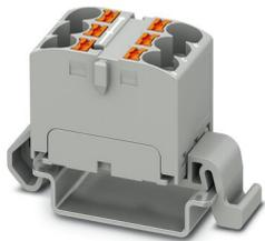
Bloc distributeur, Bloc avec orientation horizontale, tension nominale: 800 V, intensité nominale: 32 A, nombre de connexions: 6, type de raccordement: Raccordement Push-in, section : 0,2 mm<sup>2</sup> - 6 mm<sup>2</sup>, type de montage: NS 35/7,5, NS 35/15, coloris: gris
