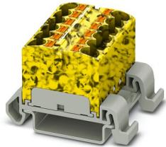
Bloc distributeur, Bloc avec orientation horizontale, tension nominale: 800 V, intensité nominale: 32 A, nombre de connexions: 12, type de raccordement: Raccordement Push-in, section : 0,2 mm<sup>2</sup> - 6 mm<sup>2</sup>, type de montage: NS 35/7,5, NS 35/15, coloris: noir/jaune
