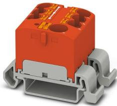
Bloc distributeur, tension nominale: 800 V, intensité nominale: 57 A, nombre de connexions: 7, type de raccordement: Raccordement Push-in, Raccordement collectif, Section de référence: 10 mm<sup>2</sup>, section : 0,5 mm<sup>2</sup> - 10 mm<sup>2</sup>, Raccordement Push-in, Dérivation, Section de référence: 4 mm<sup>2</sup>, section : 0,2 mm<sup>2</sup> - 6 mm<sup>2</sup>, type de montage: NS 35/7,5, NS 35/15, coloris: rouge
