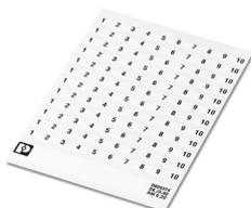
Carte de repérage, autocollante, impression horizontale avec la numérotation continue : 11 ... 20, ruban de repérage à 10 éléments avec 12 dizaines identiques, blanc, pour bloc de jonction au pas de : 6,2 mm, type de montage: collage
