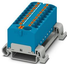
Bloc distributeur, tension nominale: 800 V, intensité nominale: 32 A, nombre de connexions: 19, type de raccordement: Raccordement Push-in, Dérivation, section : 0,2 mm<sup>2</sup> - 6 mm<sup>2</sup>, Raccordement Push-in, Raccordement collectif, Section de référence: 10 mm<sup>2</sup>, section : 0,5 mm<sup>2</sup> - 10 mm<sup>2</sup>, type de montage: NS 35/7,5, NS 35/15, coloris: bleu
