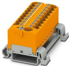
Bloc distributeur, tension nominale: 800 V, intensité nominale: 32 A, nombre de connexions: 19, type de raccordement: Raccordement Push-in, Dérivation, section : 0,2 mm<sup>2</sup> - 6 mm<sup>2</sup>, Raccordement Push-in, Raccordement collectif, Section de référence: 10 mm<sup>2</sup>, section : 0,5 mm<sup>2</sup> - 10 mm<sup>2</sup>, type de montage: NS 35/7,5, NS 35/15, coloris: orange
