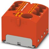
Bloc distributeur, tension nominale: 450 V, intensité nominale: 57 A, nombre de connexions: 7, type de raccordement: Raccordement Push-in, Raccordement collectif, Section de référence: 10 mm<sup>2</sup>, section : 0,5 mm<sup>2</sup> - 10 mm<sup>2</sup>, Raccordement Push-in, Dérivation, Section de référence: 4 mm<sup>2</sup>, section : 0,2 mm<sup>2</sup> - 6 mm<sup>2</sup>, type de montage: encliquetage sur l'adaptateur de profilé, Montage direct avec bride, Volant, coloris: rouge
