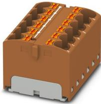
Bloc distributeur, pontage interne, tension nominale: 450 V, intensité nominale: 32 A, nombre de connexions: 12, type de raccordement: Raccordement Push-in, section : 0,2 mm<sup>2</sup> - 6 mm<sup>2</sup>, type de montage: collage, coloris: marron
