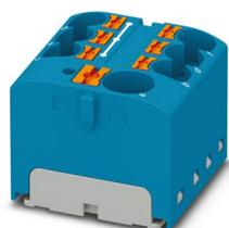
Bloc distributeur, pontage interne, tension nominale: 450 V, intensité nominale: 57 A, nombre de connexions: 7, type de raccordement: Raccordement Push-in, Raccordement collectif, Section de référence: 10 mm<sup>2</sup>, section : 0,5 mm<sup>2</sup> - 10 mm<sup>2</sup>, Raccordement Push-in, Dérivation, Section de référence: 4 mm<sup>2</sup>, section : 0,2 mm<sup>2</sup> - 6 mm<sup>2</sup>, type de montage: collage, coloris: bleu
