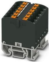
Bloc distributeur, Bloc avec orientation horizontale, tension nominale: 690 V, intensité nominale: 24 A, nombre de connexions: 12, type de raccordement: Raccordement Push-in, section : 0,14 mm<sup>2</sup> - 4 mm<sup>2</sup>, type de montage: NS 15, coloris: noir
