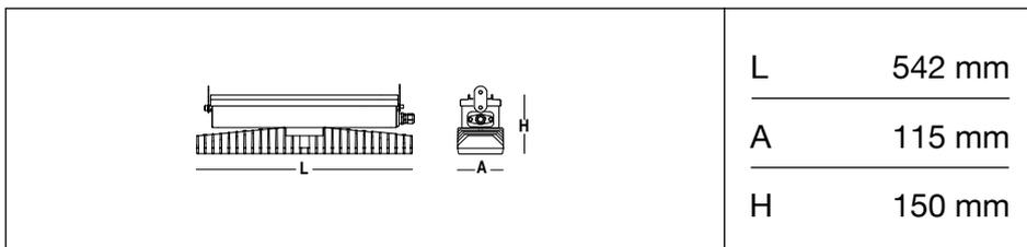
**Appareil industriel flux lumineux élevé et un haut rendement lumineux conçu avec les technologies les plus innovantes pour les environnements avec la température jusqu'à 45°C.**
