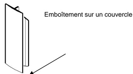
Le joint de couvercle se glisse et se positionne sur l'extrémité d'un couvercle, l'autre côté reste disponible pour réouverture
