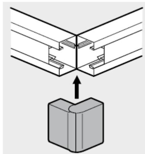
Permet la jonction extérieure de deux morceaux de gouttes de même section :
