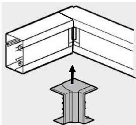
Permet la jonction intérieure de deux morceaux de gouttes de même section :
