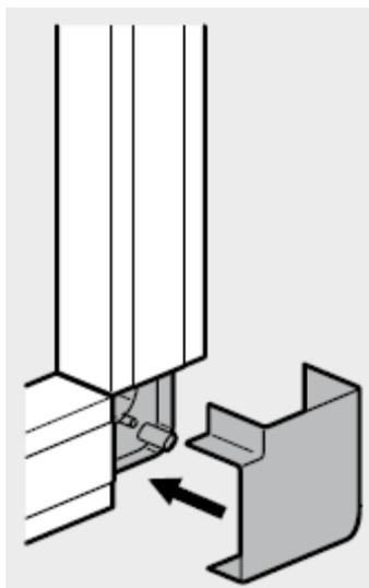
Permet la jonction en angle plat de deux morceaux de goulottes de même section :
