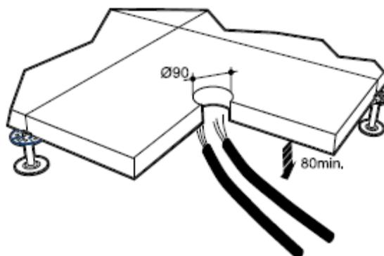
Dans chape béton avec boîte d'encastrement béton réf 28009 :
