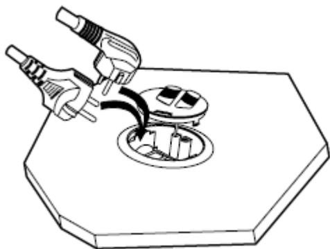
Le support d'appareillage à l'intérieur de la boîte 3 modules bascule permettant d'insérer une fiche droite ou une fiche coudée
