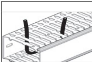
Le couvercle se pose facilement sur la goulotte par encliquetage frontal ou par rotation. L'ouverture se fait sans outils.
