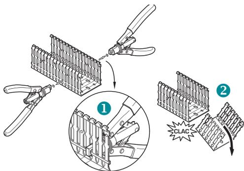
Elles permettent de réaliser une jonction en T entre une goulotte verticale et horizontale sur toute la hauteur, sans obstacle.
