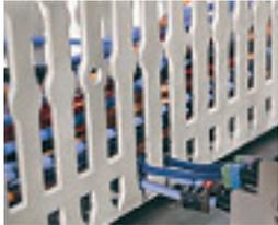
La hauteur entre le pied de la goulotte et la poutre de renfort ne dépasse pas 20 % de la hauteur totale. Le passage d'un fil au plus près de la platine est possible en supprimant le lien entre les 2 languettes à l'aide de la pince Segma.
