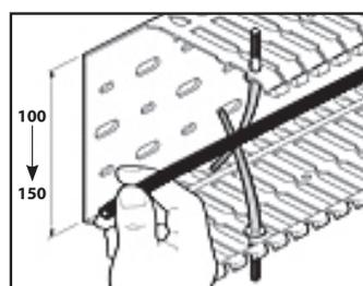
Pour les goulottes de grande largeur, l'utilisation de 2 agrafes en vis-à-vis permet de maintenir les fils.
