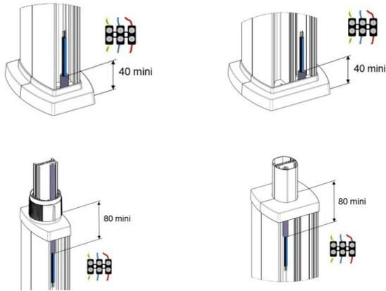
L'arrivée des câbles peut être réalisée par le sol, via faux plancher/passage de plancher, ou par le plafond.
