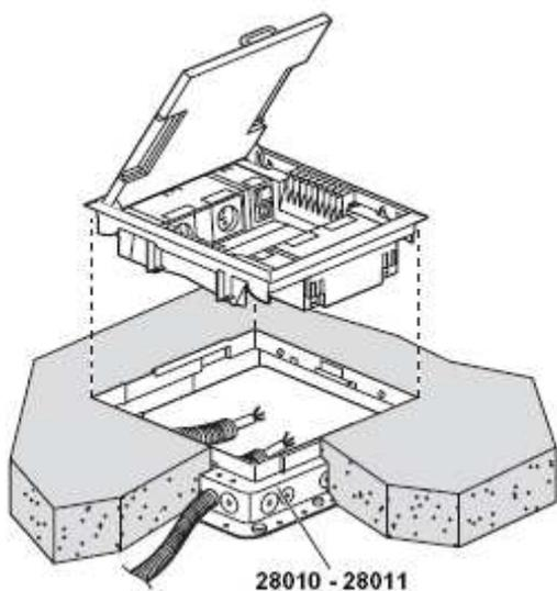
La hauteur minimum pour installer une boîte de sol à hauteur réduite doit être de 65mm.
