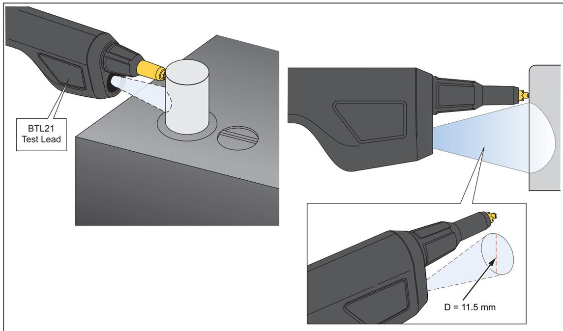
Figure 4-5. Mesure de la température du pôle d'une batterie
