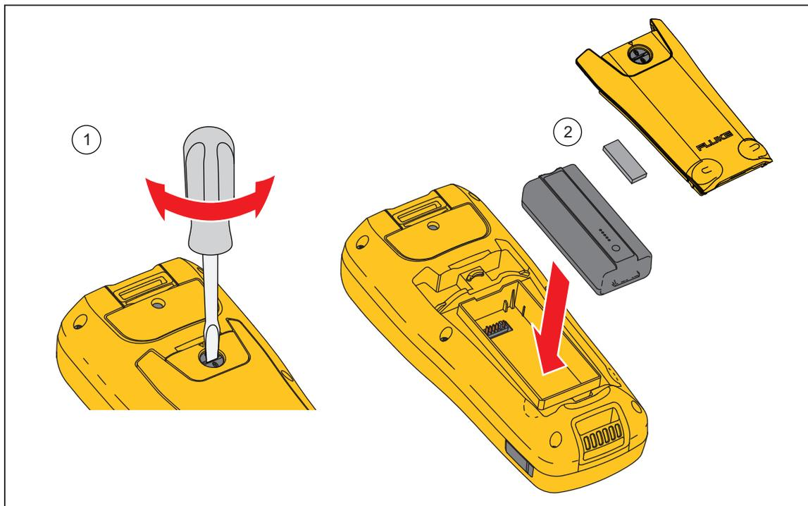
Figure 7-1. Installer ou remplacer un pack de batterie
