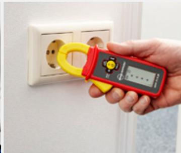
**La fonction de tension sans contact (TSC)** vérifie la présence de tension.
