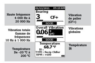
Ecran des résultats de mesure d'échantillon indiquant une échelle de gravité à quatre niveaux (*Good, Satisfactory, Unsatisfactory, Unacceptable* (Bon, satisfaisant, non satisfaisant, inacceptable) pour les vibrations globales et de roulement
