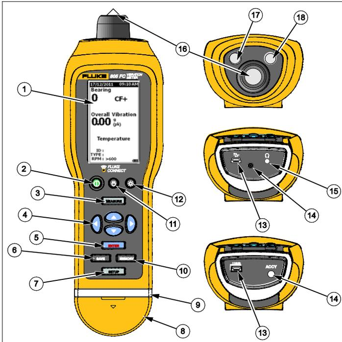
**Figure 1. Branchements et commandes de l'appareil de mesure**
