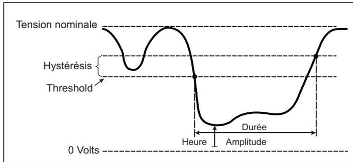
Figure 9. Caractéristiques d'une coupure de tension
