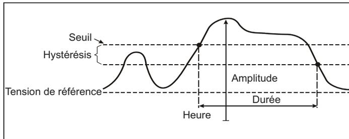
**Figure 7. Caractéristiques d'une hausse de tension**
