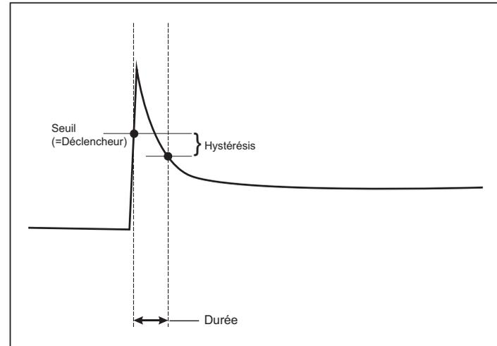
Figure 10. Caractéristiques du démarrage et rapport avec le menu de démarrage
