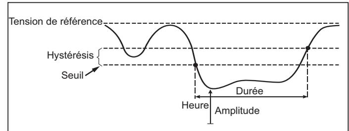
**Figure 8. Caractéristiques d'un creux de tension**
