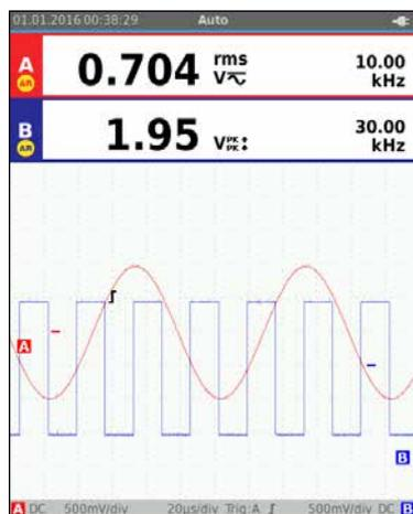
Le déclenchement Connect-and-View™ avec la fonction AutoReading reposant sur la technologie Fluke IntellaSet™ donne un accès rapide aux données dont vous avez besoin.
