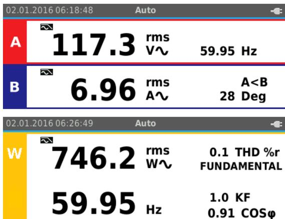
Obtenez facilement des caractéristiques de puissance clés pour valider un système électrique.
