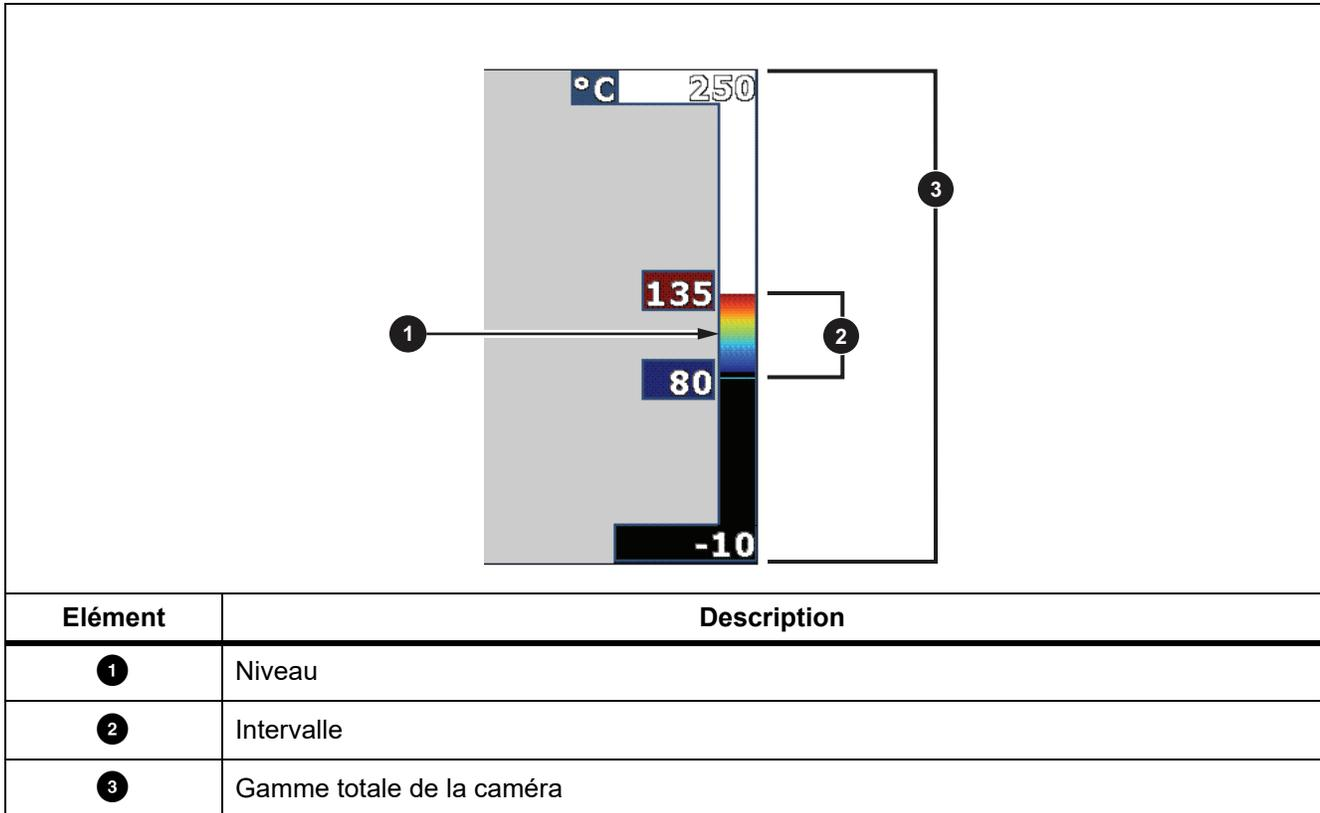
Dans le mode Niveau/Intervalle automatique, la caméra détermine le **Niveau/Intervalle** en fonction des températures définies dans la **Gamme**.
