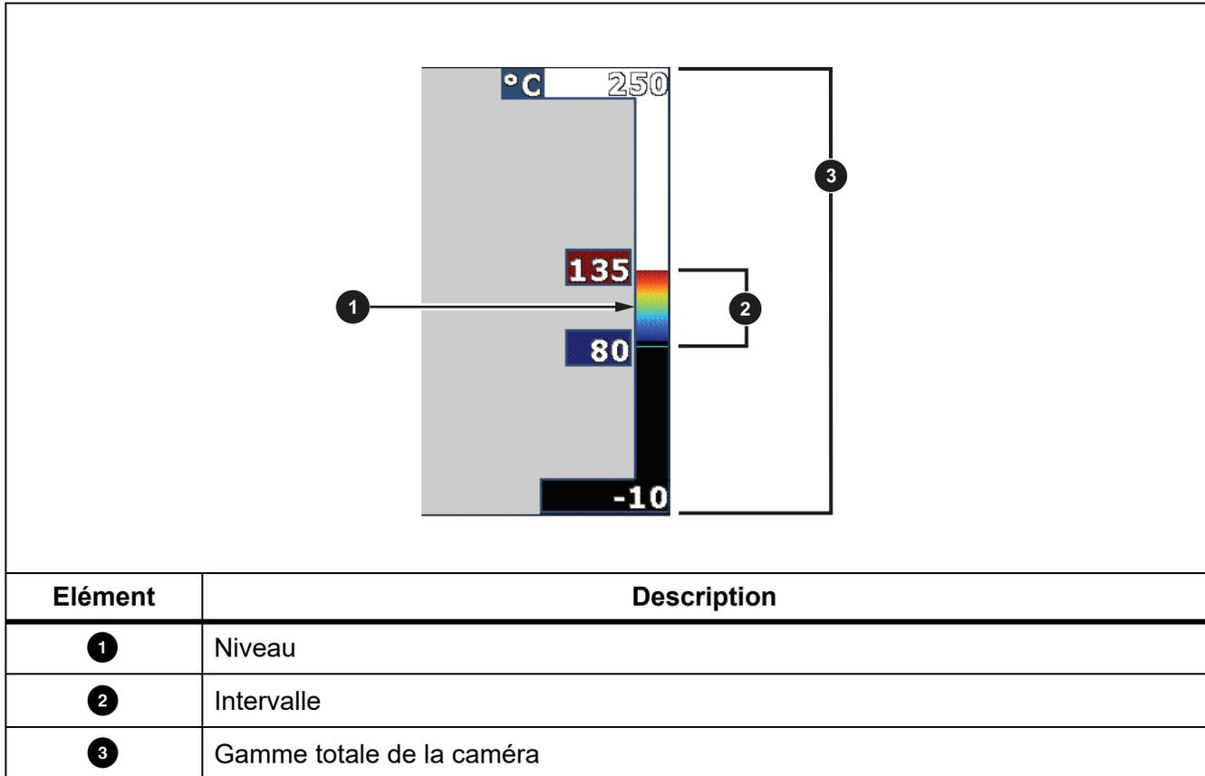
Dans le mode Niveau/Intervalle automatique, la caméra détermine le **Niveau/Intervalle** en fonction des températures définies dans la **Gamme**.
