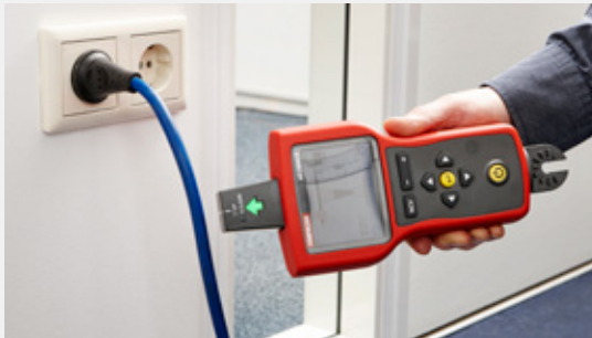
Détection de tension sans contact (NCV).
