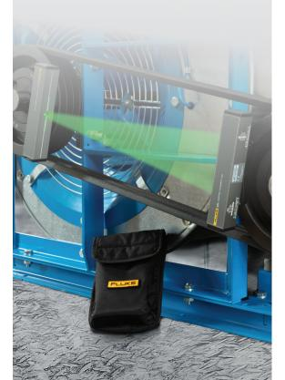
C'est un fait connu : toutes les machines rotatives sont susceptibles de présenter des défauts d'alignement. Sur un système à poulies, l'alignement correct réduit l'usure des courroies, les pertes d'énergie et les vibrations des machines, renforçant ainsi le niveau des performances.
