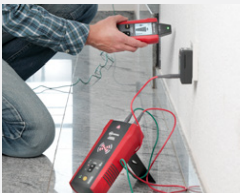
Traçage des câbles sous et hors tension
