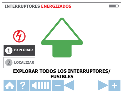
Figura 3.3c: Modo de SCAN (LECTURA): lectura de disyuntores/fusibles
