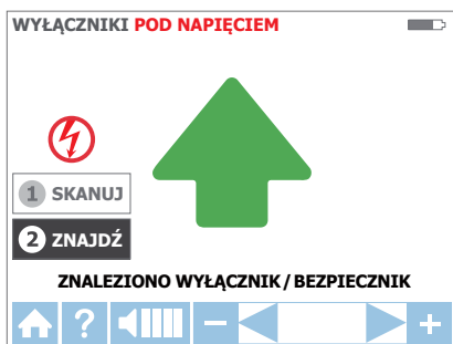
Rysunek 3.3f: Tryb LOKALIZUJ – zidentyfikowany wyłącznik/bezpiecznik
