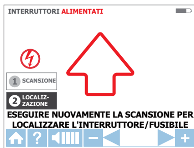
Figura 3.3d: Modalità LOCATE (Trova) – Ricerca di salvavita/fusibili corretti
