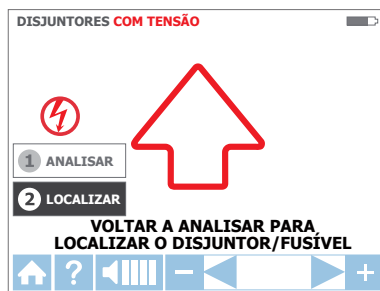
Figura 3.3d: Modo LOCALIZAR - Procurar o disjuntor/fusível correto
