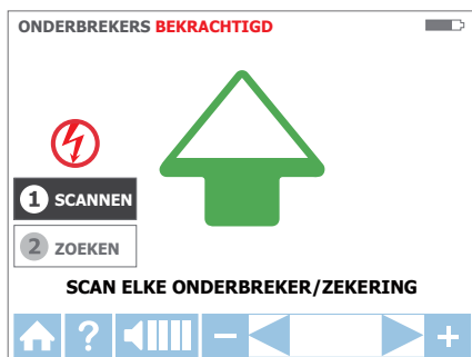
Afbeelding 3.3c: SCAN-modus – Stroomonderbrekers/zekeringen scannen
