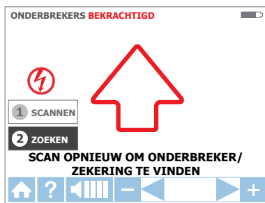
Afbeelding 3.3d: Modus ZOEKEN – Zoeken naar juiste stroomonderbreker/zekering
