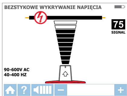
Rysunek 3.4: Wykrywanie napięcia w trybie NCV z użyciem czujnika z końcówką
