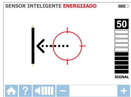
Figura 3.1e: Cable a la izquierda
