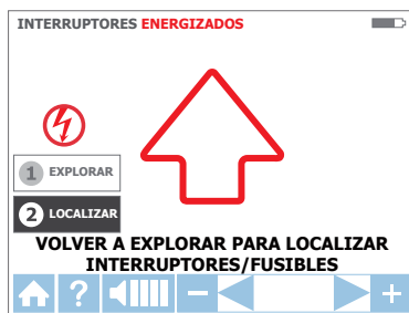
Figura 3.3d: Modo LOCATE (UBICACIÓN): búsqueda del disyuntor/fusible correcto
