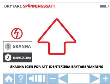
Figur 3.3d: LOKALISERA-läge - Söker efter rätt brytare/säkring
