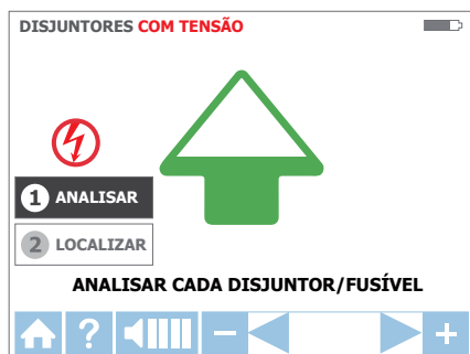
Figura 3.3c: Modo PROCURAR - Procurar disjuntores/fusíveis
