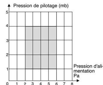
Les caractéristiques sont données à pression d'alimentation 6 bars et pour une détection au milieu de passage.
