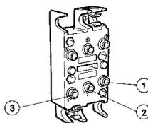
Les cellules du système modulaire se montent à l'aide de deux vis sur l'embase. Un détrompeur prévu sur chaque cellule évite toute erreur de montage.
