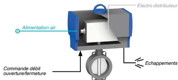
Les actionneurs pneumatiques pour robinets et vannes Quart de tour ou proportionnelles permettent d'automatiser les commandes d'ouverture/fermeture et les variations de débit. Le vérin d'actionnement pneumatique est mis en œuvre à travers un distributeur d'air intégré dans le corps de vannes commandé par une électrovanne.
