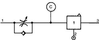
Remplissage de la capacité à travers le réducteur de débit jusqu'au moment où l'on atteint le seuil de commutation du relais de sortie (positif ou négatif).
