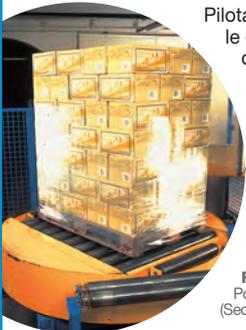
Pilotage du moteur entraînant le déroulement du film d'emballage. Commande de coupe du film après soudure et contrôle de la durée des cycles moteur
