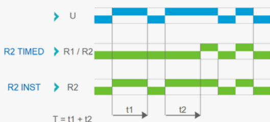
Fonction AMt : Relais temporisé à la mise sous tension (Temporisation ON, Mémoire totale : une temporisation)
