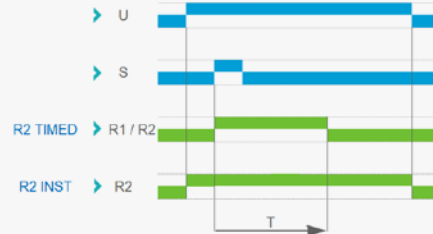
Fonction C : Relais temporisé à la coupure avec signal de commande
