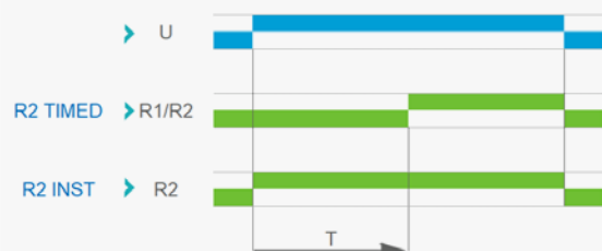
Fonction B : Relais d'intervalle avec signal de commande
