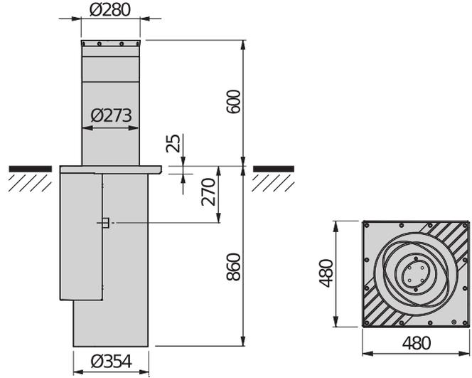
Borne de dissuasion automatique et oléodynamique, à haute résistance, avec centrale oléodynamique incorporée. Adaptée à la protection de sites sensibles – avec la version spéciale « SD » qui maintient le fût en position haute en cas de panne de courant, ainsi que d'espaces publics – avec la version standard qui permet d'abaisser spontanément le fût en cas d'interruption du courant.
