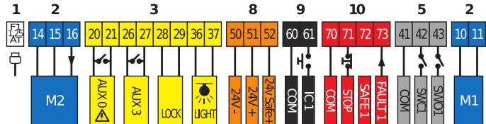
Panneau de commande à afficheur pour un ou deux opérateurs électromécaniques de 24 V pour portes de garage basculantes de 230 V/200 W.
