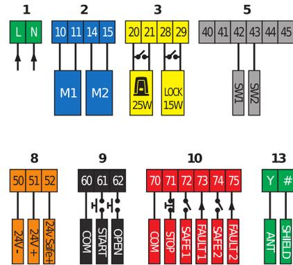
Panneau de commande à interrupteurs de programmation (dip switch) et potentiomètres pour un ou deux opérateurs de 24 V pour portails battants de 230 V/80 W.
